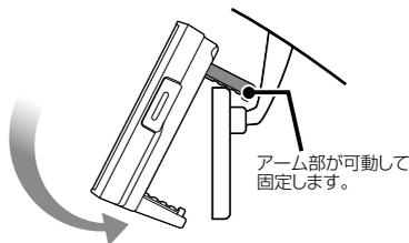
振動により落下しないために、アーム部分を曲げずミラーに本体を密着させ、しっかり取り付け付けてください。
