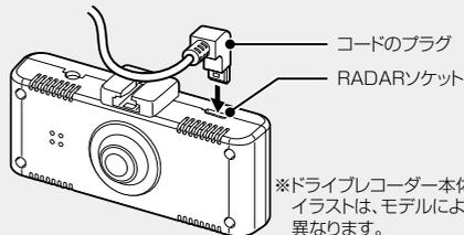
プラグの向きとソケットの向きに気を付けて差し込んでください。相互通信コードのプラグをドライブレコーダーのRADARソケット、レーダーディテクターの外部入力ソケットに「カチッ」と音がするまで差し込んでください。隙間があると接続不良になり、映像出力やリモコン操作などができないことがあります。
