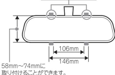
・本製品をアンテナ用アームを使用して取り付けの場合、ルームミラーとフロントガラスの間に90mm以上のスペースが必要です。
