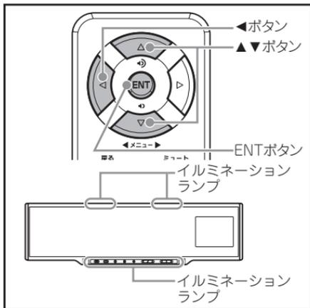
ミラーの上下にある「イルミネーションランプ」が青色に光り、本製品をライトアップします。「イルミネーションランプ」の点灯/消灯は、設定メニューで設定を変更して切り替えます。
