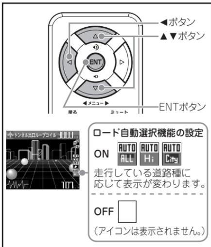
GPS を用いて現在走行している道路の種類（高速道／一般道）を自動で判別し、その道路に適した GPS 警告をお知らせします。
