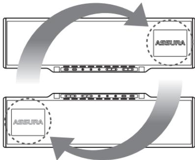
※ 工場出荷時のままで本体を上下逆に取り付けられた場合、ディスプレイの表示も上下逆になります。画面反転機能を ON にして、表示画面を調整してください。
