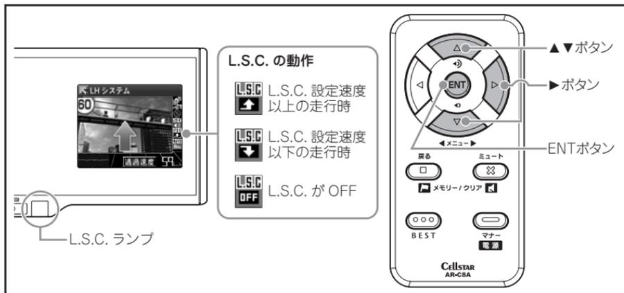
GPS 測位中、お車の低速走行や停止時にレーダー警告音を自動的にミュート（消音）します。
