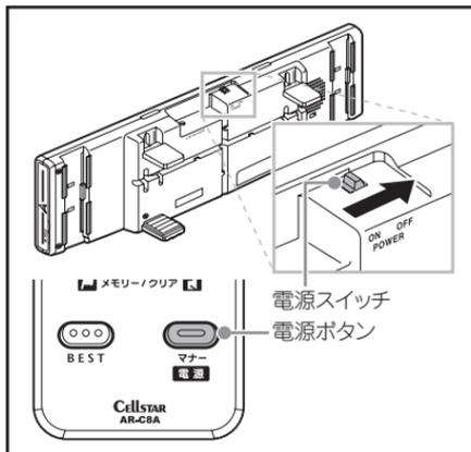
**1** 本体の「電源スイッチ」を「OFF」にします。またはリモコン／本体の「電源ボタン」を約3秒間押し続けます。
