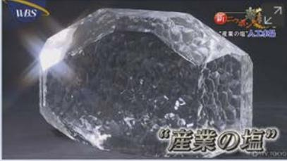
日本の産業力を支える“素材”に注目する企画「新・ニッポンの素材力」。1回目は様々な電子機器に欠かせない電子部品の素材となる「人工水晶」に注目しました。今回大江キヤスターが取材したのは、人工水晶を大規模に作っている「エプソンアトミックス」の工場。人工水晶は天然水晶を一度溶かし、核となる「種水晶」を土台にして再び結晶化させることで純度99.99999%という純度の高い水晶に育てます。種水晶の厚みは1ミリメートル。高温・高圧の環境のもとで1日に0.5ミリずつ成長し、8キログラムに育てるには半年かかります。エプソンアトミックスでは8キログラムの人工水晶を1度に200個ほど作ることができる世界でもトップクラスの技術を持っています。その重要性から“産業の塩”とも呼ばれる水晶部品は、今後も自動運転やIoT、大容量高速通信などの技術には不可欠。人工水晶は今後も注目されていくこととなります。
