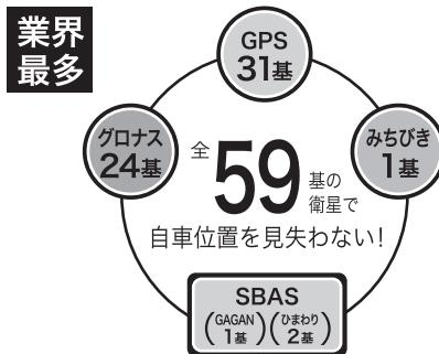
\* SBASとは「satellite-based augmentation system」の略で静止衛星を介して補強情報を伝送するGPS補強システムの一つです。
