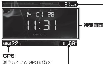
測位している GPS の数を表示します。未測位の場合は、「00」と表示します。
