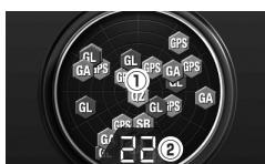
① 現在、測位している GPS 衛星の種類や位置を表示します。
