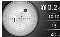
① 車両にかかる G をポイントで表示します。G が大きくなるほどポイントが外側に移動します。
