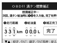
**8** 満タンに補給した給油量を入力してENTボタンを押す
