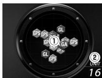
① 現在、測位している GPS 衛星の種類や位置を表示します。
