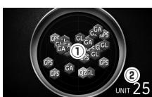
① 現在、測位している GPS 衛星の種類や位置を表示します。
