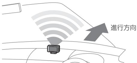
レーザー式オービスからのレーザー光の受信状況を元に、受信レベルを2段階（強、弱）で判定して、テキストと効果音の強弱で警告します。
