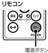
\* リモコンによる電源ON操作は、リモコンにより電源OFFした後、有効となります。
