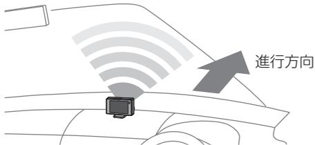
レーザー式オービスからのレーザー光の受信状況を元、受信レベルを2段階（強・弱）で判定して、テキストと効果音の強弱で警告します。
