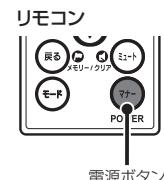
\* リモコンによる電源ON操作は、リモコンにより電源OFFしたあと、有効となります。
