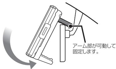
振動により落下しないために、アーム部分を曲げずミラーに本体を密着させ、しっかり取り付けてください。
