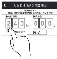
8 満タンに補給した給油量の数値を直接タップして設定する
