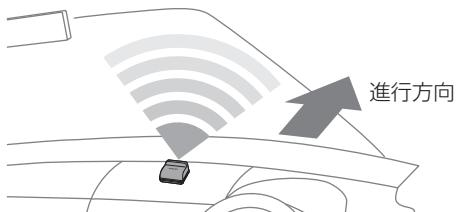
レーザー式オービスからのレーザー光の受信状況を元に、受信レベルを2段階（強、弱）で判定して、テキストと効果音の強弱で警告します。
