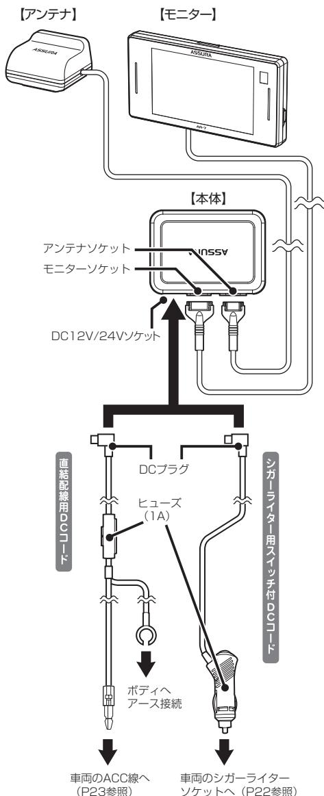
1 本体に取付用固定テープを貼り付け、車両に固定する
