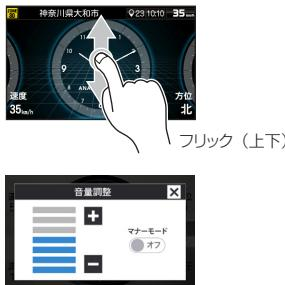
+ボタンで音量を微調整、またマナーモードボタンでマナーモード（P104参照）も設定できます。
