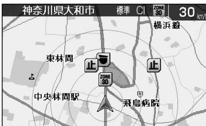
無線LAN でのインターネット接続をし、「ASSURA+Link アイコン信頼度」を高・中・低に設定すると ASSURA+Link に投稿されたリアルタイムのポイント情報をアイコンでお知らせします。
