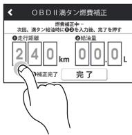
8 満タンに補給した給油量の数値を直接タップして設定する
