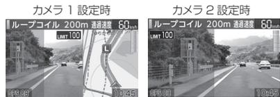
設置された取締機の位置は、下記のように映像画面の一部を赤く点滅させてお知らせします。
