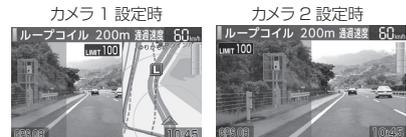
設置された取締機の位置は、下記のように映像画面の一部を赤く点滅させてお知らせします。
