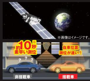
日本のほぼ真上を通りる軌道を持つ準天頂衛星みちびき(QZSS)に対応しました。準天頂衛星システムはGPSを補完するシステムです。GPSでは不正確な測位ができない山間部や都心部の高層ビル街でも、より高精度な位置測定ができるようになりました。
