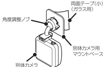
\* 必要に応じて、先に別体カメラ用マウントベースを車両側に取り付けてから別体カメラを設置してください。
