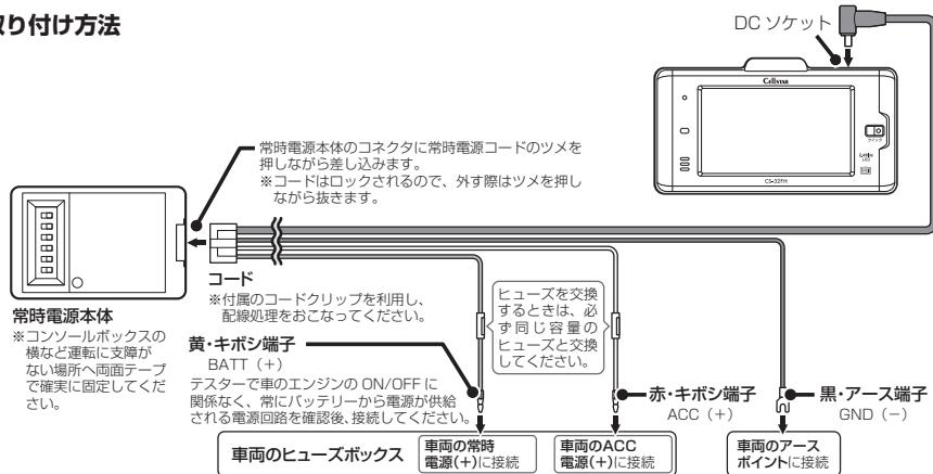
\* オプションの常時電源コードに付属の取扱説明書をよく読み、正しく設定の上、ACCがOFFの時に接続してください。
