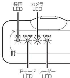
microSDカードが挿入されていない、もしくはカメラの初期化エラーなどが発生した場合は、次のようなLEDの状態とボイスアシストでお知らせします。
