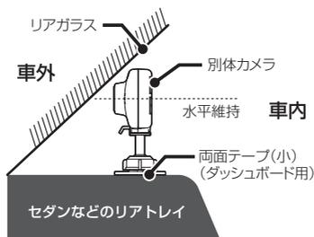
\* 別体カメラの上下切り替えスイッチを↓、正像鏡像切り替えスイッチをM（鏡像）に変更してください。（P25参照）
