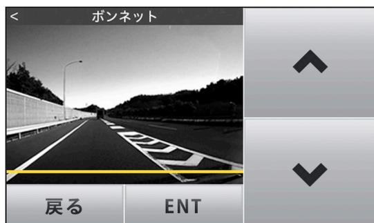
1. 画面を見て黄色の線がボンネットの高さと同じになるようにセーフティレーダーの▲▼ボタンで調整する。
