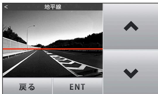
1. 画面を見て赤色の線が道路の先端にくるようにセーフティレーダーの▲▼ボタンで調整する。
