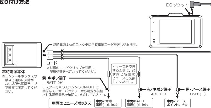
\* オプションの常時電源コードに付属の取扱説明書をよく読み、正しく設定の上、ACCがOFFの時に接続してください。
