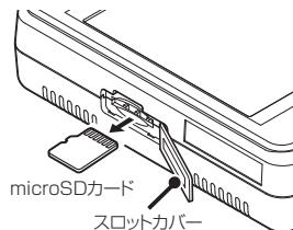
**2** 本体のスロットカバーをめくり、microSDカードを軽く押し込む。
