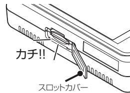
2 本体のスロットカバーをめくり、microSDカードの向きに注意してスロットに差し込む。
