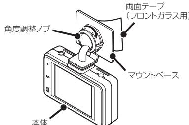
\* 必要に応じて、先にマウントベースを車両側に取り付けてから本体を設置してください。
