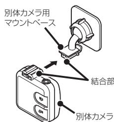
**2 両面テープ（ガラス用）を使用して別体カメラを設置する場所に取り付ける。**
