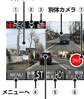
別体カメラ接続時、画面を長タップ(3秒後指を離す動作)すると、ディスプレイに表示される映像が次のように切り替わります。
