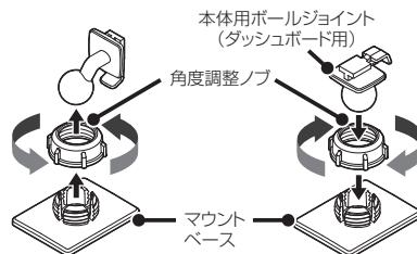
\* 先に本体用ボールジョイントを角度調整ノブに差し込み、マウントベースに取り付けてください。
