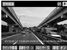
パーキングモードがオンになると、画面に「P」のアイコンが表示されます。内蔵の3Gセンサーにより、10分以上振動が感知しない場合、画面が消え、LEDが遅く点滅し、パーキングモードの動作となります。
