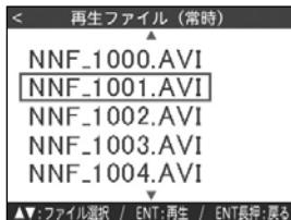
4 **Aボタン**または**Cボタン**を押して再生したいファイルを選択し、**Bボタン**を押して確定する。
