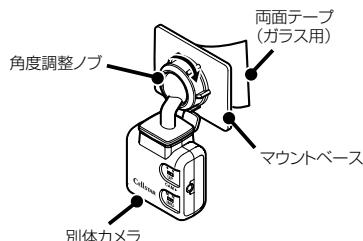
\* 必要に応じて、先にマウントベースを車両側に取り付けてから別体カメラを設置してください。
