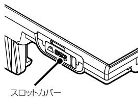
1 本体のスロットカバーをめくり、microSDカードを軽く押し込む。
