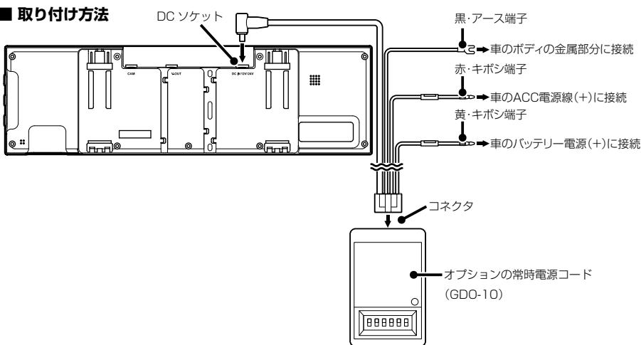
\* オプションの常時電源コード（GDO-10）に付属の取扱説明書をよく読み、正しく設定の上、ACCがOFFの時に接続してください。
