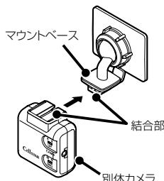
2 両面テープ（ガラス用）を使用して別体カメラを設置する場所に取り付ける。
