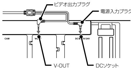
**2 レーダーディテクター接続コードの外部入力コネクターをレーダーディテクターの外部入力ソケットに差し込む。**
