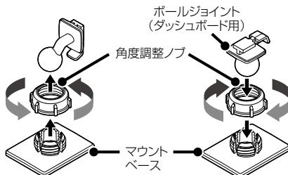
\* 先にボールジョイントを角度調整ノブに差し込み、マウントベースに取り付けてください。
