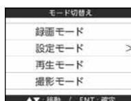
2 AボタンまたはCボタンを押して【設定モード】に移動し、Bボタンを押して確定する。
