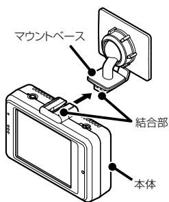
**3** 角度調整ノブを右側に回して本体を固定する。
