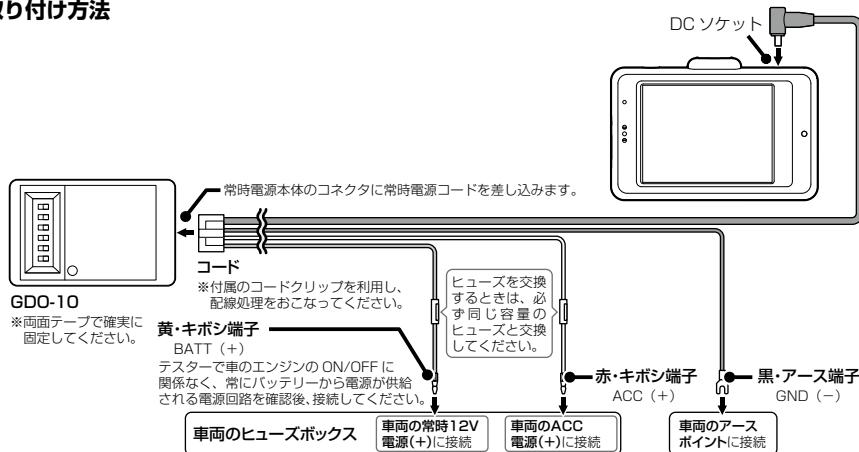
\* オプションの常時電源コード（GDO-10）に付属の取扱説明書をよく読み、正しく設定の上、ACCがOFFの時に接続してください。
