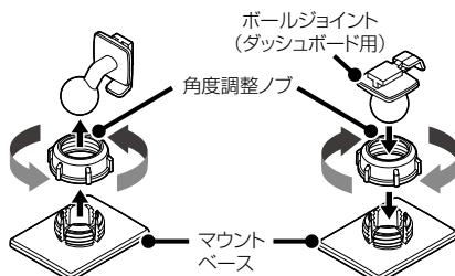
\* 先にポールジョイントを角度調整ノブに差し込み、マウントベースに取り付けてください。
