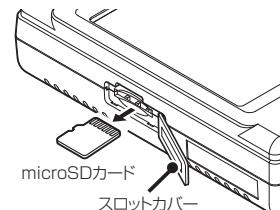
**2** 本体のスロットカバーをめくり、microSDカードを軽く押し込む。
