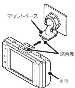
**3** 角度調整ノブを右側に回して本体を固定する。
