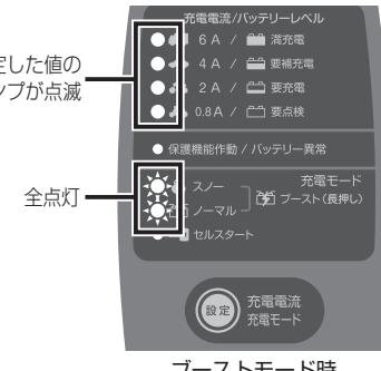
ブーストモードが正常に終了した場合、自動でノーマルモードに移行します。バッテリーが回復しなければ、バッテリー異常と判断しランプが点滅し、動作停止します。
