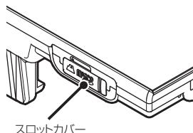
1 本体のスロットカバーをめくり、microSDカードを軽く押し込む。
