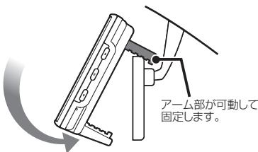
振動により落下しないために、アーム部分を曲げずミラーに本体を密着させ、しっかり取り付けてください。
