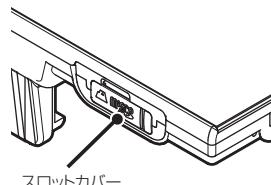
1 本体のスロットカバーをめくり、microSDカードの向きに注意してスロットに差し込む。
