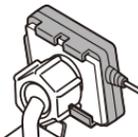
**3** GPSユニットに両面テープを貼り付け、ドライブレコーダー本体の取扱説明書をよくお読みの上、しっかり設置します。
