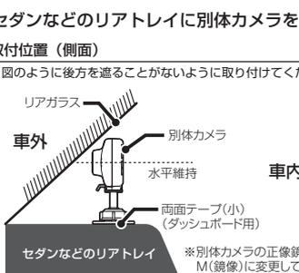
※別体カメラの正像鏡像切り替えスイッチをM(鏡像)に変更してください。
