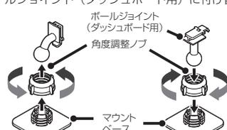
※先に別体カメラ用ボールジョイントを角度調整ノブに差し込み、マウントベースに取り付けてください。
