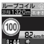
車両が複数あるループコイルを通過するのにかかった時間から走行速度を計測し、違反車両をカメラで撮影します。
