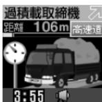
路面に設置された重量測定用の踏み板と道路上方の監視カメラによって、トレーラーなどの大型車の重量オーバーを監視します。
