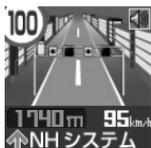
通行車両をデジタルカメラで撮影し、その写真画像のブレなどから走行速度を算出することで速度違反車両を特定します。現在このNHシステムはNシステムとは異なった目的での車両識別用監視カメラとして稼働していますが、将来的に速度取締りをおこなう可能性があります。
