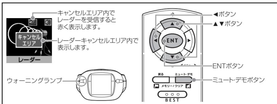
レーダー警告音が必要ないと思われるエリアの半径約 200m 圏内で、レーダー警告音をキャンセル（消去）することができます。
