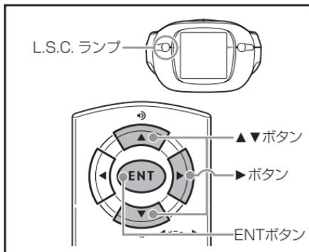
GPS 測位中、お車の低速走行や停止時にレーダー警告音を自動的にミュート（消音）し、GPS 測位していない場合は、お車の振動が少ない状態のときに警告音をミュートします。
