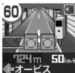
レーダー波（マイクロ波）を車両に当てて走行速度を計測し、違反車両をカメラで撮影します。
