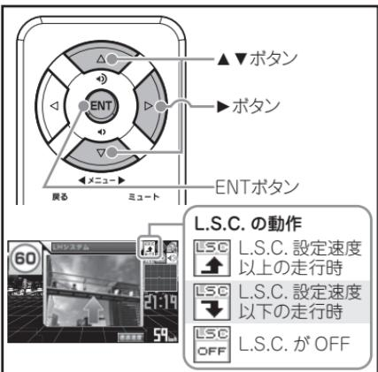
GPS 測位中、お車の低速走行や停止時にレーダー警告音を自動的にミュート（消音）します。
