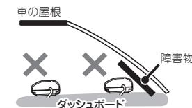
・一部車種のウィンドウに採用されている熱反射ガラスは、電波の透過率が低いためGPS信号やレーダー波の受信がしにくい場合やできない場合があります。熱反射ガラスの使用の有無は車両のディーラーやメーカーへお問い合わせください。
