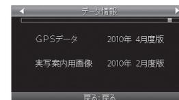
データの更新が失敗した場合、以下の画面が表示されるので電源を入れなおしてください。再度、自動的にデータの更新が開始します。
