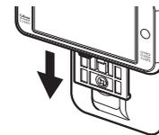
4 マウントベースにダッシュボード取付用両面テープを貼り付け、ダッシュボードに固定する。
