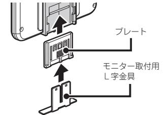
2 モニター取付用L字金具にモニター取付用L字金具用両面テープを貼り付け、ダッシュボードに固定する。
