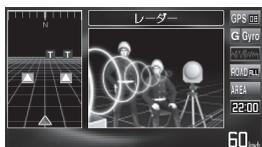
レーダー警告音が必要ないと思われるエリアでは、GPSを使って半径約200m圏内のレーダー警告音をキャンセル（消去）することができます。
