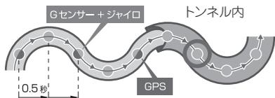
トンネルの中でもGセンサー+ジャイロセンサーが働いて自車位置を特定できます。
