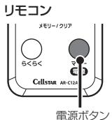
\* リモコンによる電源ON操作は、リモコンにより電源OFFした後、有効となります。
