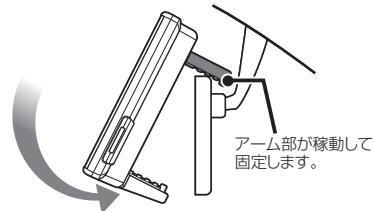
振動により落下しないために、アーム部分を曲げずミラーに本体を密着させ、しっかりと取り付けてください。
