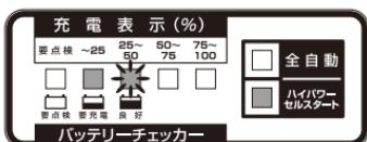
しばらくすると、ハイパワーセルスマートランプが点灯しバッテリーチェッカー表示から充電表示に切替わります。
