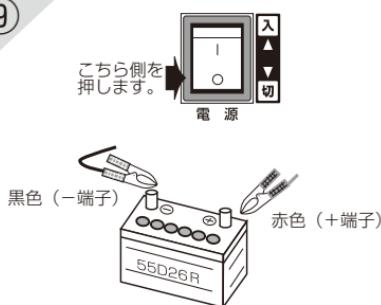
電源スイッチを切り、バッテリーから充電クリップを外してAC電源コードをコンセントから抜いてください。
