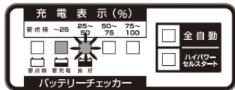
充電が終了すると自動的に電源が切れ、バッテリーチェッカー表示に切替わり、全自動ランプが消灯します。
