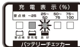
バッテリーを接続すると、バッテリーチェッカーが働き、現状のバッテリーの状態を表示します。
