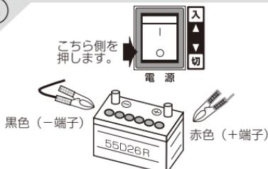
エンジンが始動したら、電源スイッチを切り、充電クリップをバッテリーから外し、AC電源コードをコンセントから抜いてください。
