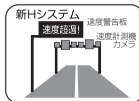
新Hシステムは方式の異なったレーダー波を使用しているため、レーダー警告動作が短くなることがあります。このシステムでは事前に「速度超過」と表示され、速度警告板に表示されます。その警告を無視した違反車両をカメラでデジタル撮影します。
