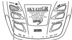
2. 「⑯フラッシュモニター」で約3秒間の表示中に「⑤DIGITAL・HELI/350.1MHzボタン」を押して設定を切替えます。押すたびにランプの表示が変わり約3秒後に設定状態をアナウンスします。
