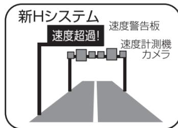
新Hシステムはレーダー波と異なった種類の電波を使用しているため、レーダーブザー開始距離が短くなることがあります。このシステムでは事前に「速度超過」などと速度警告板に表示されます。その警告を無視した違反車両をカメラでデジタル撮影します。
