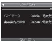
データの更新が失敗した場合、以下の画面が表示されるので電源を入れなおしてください。再度、自動的にデータの更新が開始します。
