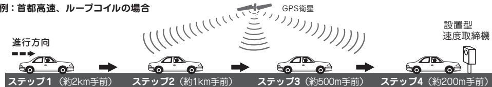
\* 距離のお知らせは、走行状況によって2km先/2km以内、1km先/1km以内、500m先/500m以内と変化します。
