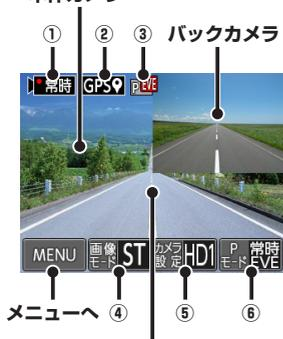
バックカメラ接続時、画面をロングタップ (3秒後指を離す動作) すると、ディスプレイに表示される映像が次のように切り替わります。
