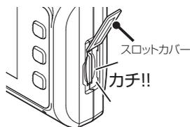
2 本体のスロットカバーをめくり、microSDカードの向きに注意してスロットに差し込む。
