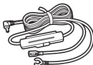
車両のヒューズボックス、ACC 線から直接電源を取る場合に使用します。
