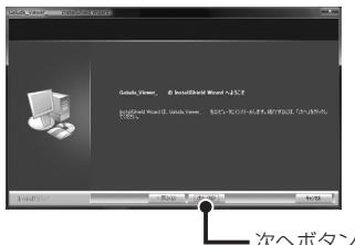
**1** 付属のビューアーソフト収録のCD-ROMをパソコンにセットし、CD-ROMを開き、「setup.exe」をダブルクリックする。
