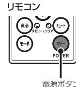
\* リモコンによる電源ON操作は、リモコンにより電源OFFした後、有効となります。
